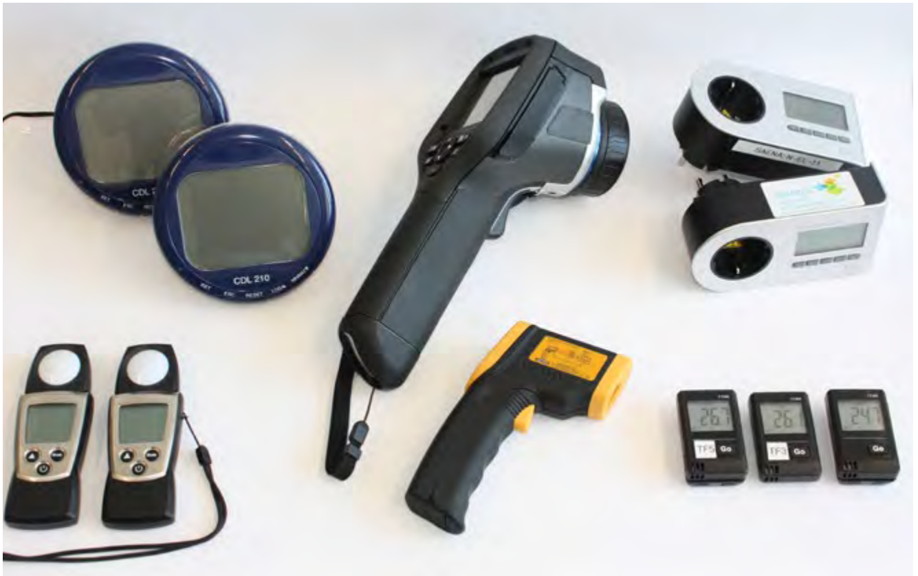
Beispielhafter Messkoffer, bestehend aus ↑ zwei Luxmetern, zwei Stromzählern, drei Temperaturdatenloggern, zwei CO 2 -Messgeräten, einem Infrarotthermometer sowie einer Wärmebildkamera.
